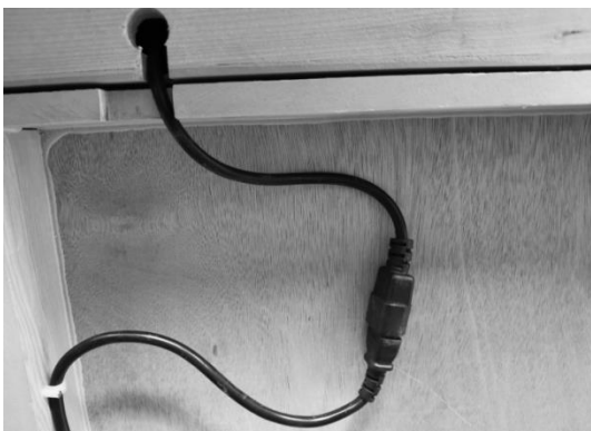
(1) Csatlakoztassa a fűtőelemek kábelét.
