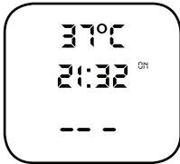
7. ábra: Előmelegítés bekapcsolva
